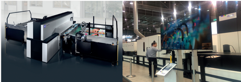
De izda. a drcha.: Delta WT 250 y Delta 130 SPC, las soluciones multi-pass y single pass de Durst basadas en la Water Technology.
